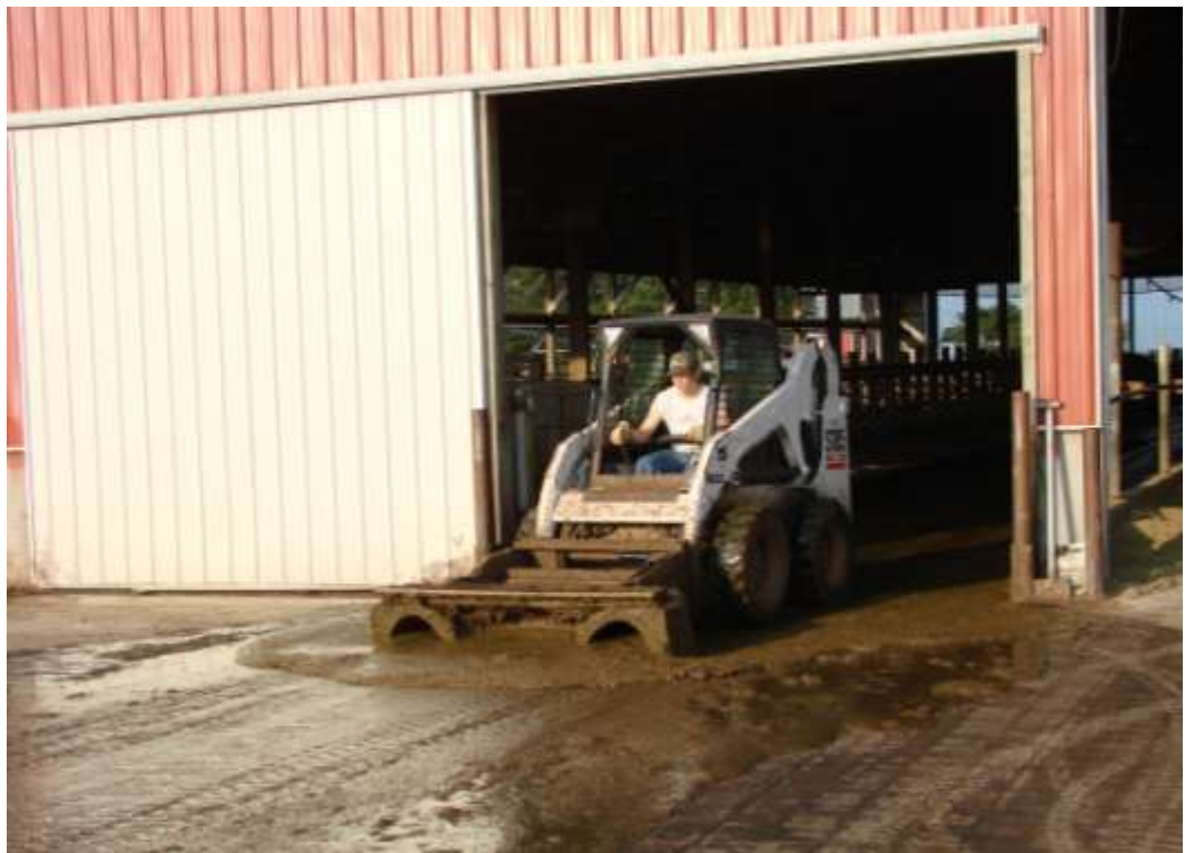
Sortie du mélange fumier/sable avec un mini-tracteur : la gratte avant est fabriquée à partir d'un demi-pneu de tracteur. Le mélange fumier/sable est directement poussé vers l'entrepôt à fumier situé à l'arrière de l'étable.
