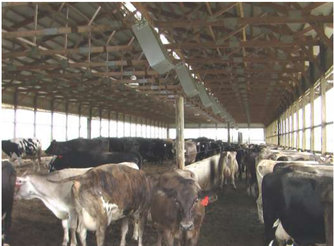
Vue de l'aire sous litière compostée et de l'allée de nettoyage donnant accès à l'allée d'alimentation.
